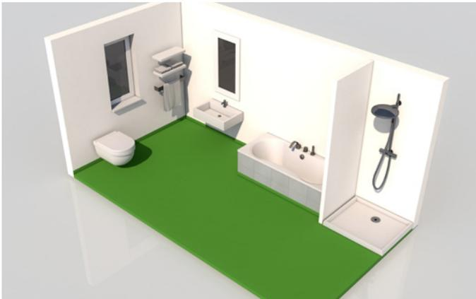
**Abb. 6:** Häusliches Bad mit Badewanne und Duschtasse mit Duschtrennung, Bodenablauf im Raum (grau = CT mit Gefälle); Anmerkung: CT deshalb, da Gefälle vorhanden, CTF ohne Gefälle
