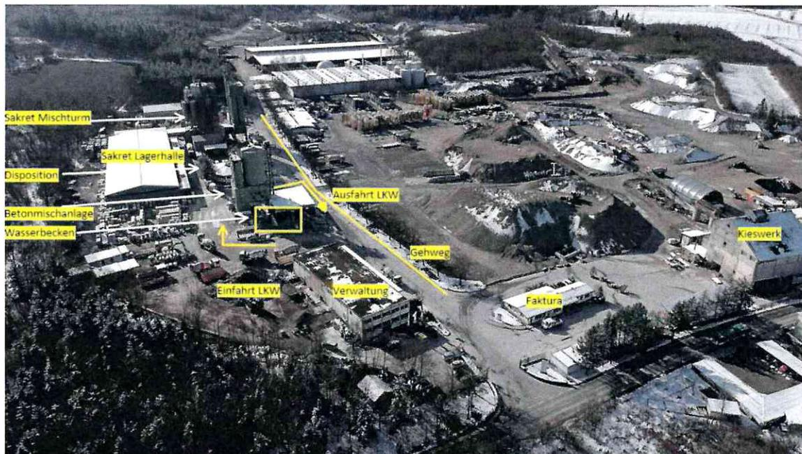
In den Wasserbecken werden das Wasch- und Schmutzwasser des Betriebs und der Produktion, sowie das Oberflächenwasser des Geländes gesammelt. Durch Rührwerke in den Becken wird das Absetzen von Feststoffen verhindert. Unter stetiger Dichtemessung des „Restwassers“ wird das Wasser zur Betonproduktion verwendet. Durch diesen Prozess kann ein erheblicher Teil Frischwasser gespart werden.
