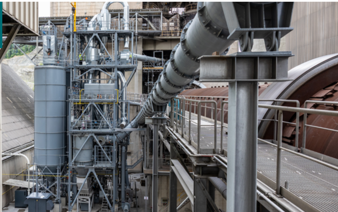
Versuchsanlage für getemperte Tone im Zementwerk Rohrdorf
